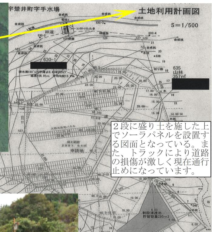
2段に盛り土をした上でソーラパネルを設置する図面となっている。また、トラックにより道路の損傷が激しく現在通行止めになっています。
